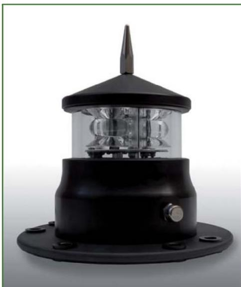
A MBL 160-HR é um farol intermitente de LED de curto e médio alcance, com excelente desempenho de seu sistema óptico e baixo consumo, equipado com diodos LED de alta intensidade, proporcionando uma faixa luminosa de até 13 milhas náuticas.
